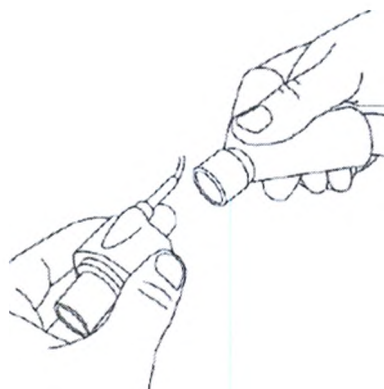
Рисунок 6-4 Подключение адаптера IRMA Вид 1
