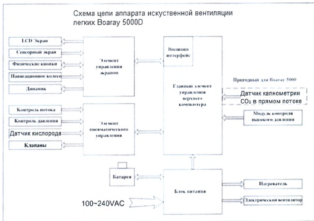
Схема А-3 Структура электрической системы
