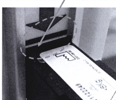
Рис. 4 Правильная установка (плотная посадка без зазора) установочной детали типа «ласточкин хвост» с направляющей типа «ласточкин хвост»
