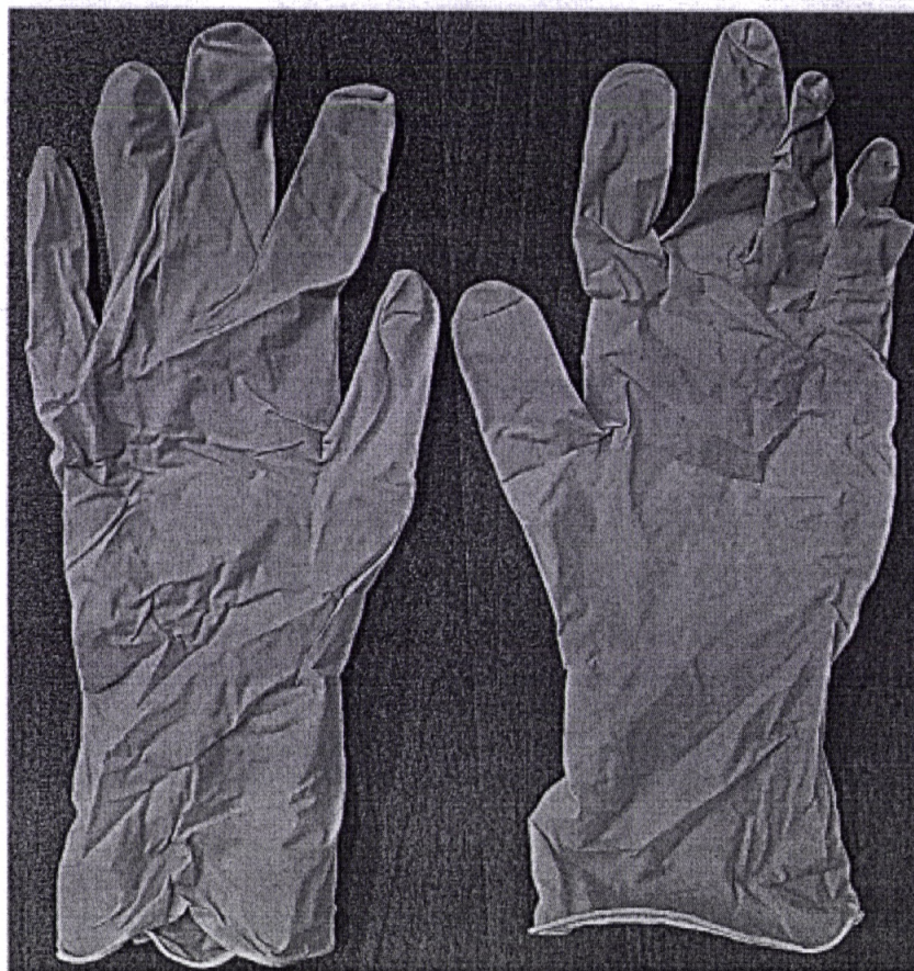
Слипшиеся образцы после ускоренного старения
